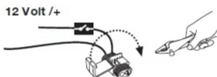
Aux points de connexion dans les circuits de l'éclairage/feux du faisceau électrique du véhicule au lieu des pinces qui se croisent avec l'isolation des câbles il est autorisé à utiliser des joints soudés (fixe) comme ci-dessous :
